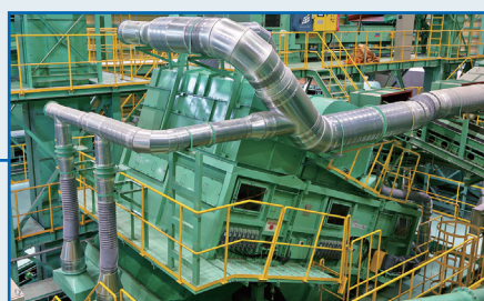
風力・振動・傾斜を活用し素材を比重別に選別
